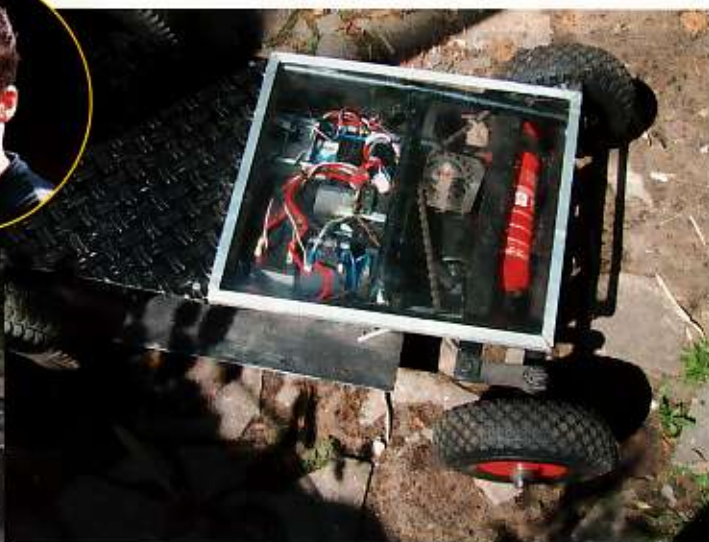
Accu's, elektronica, stuurinrichting en pneumatiek, met beschermkap
